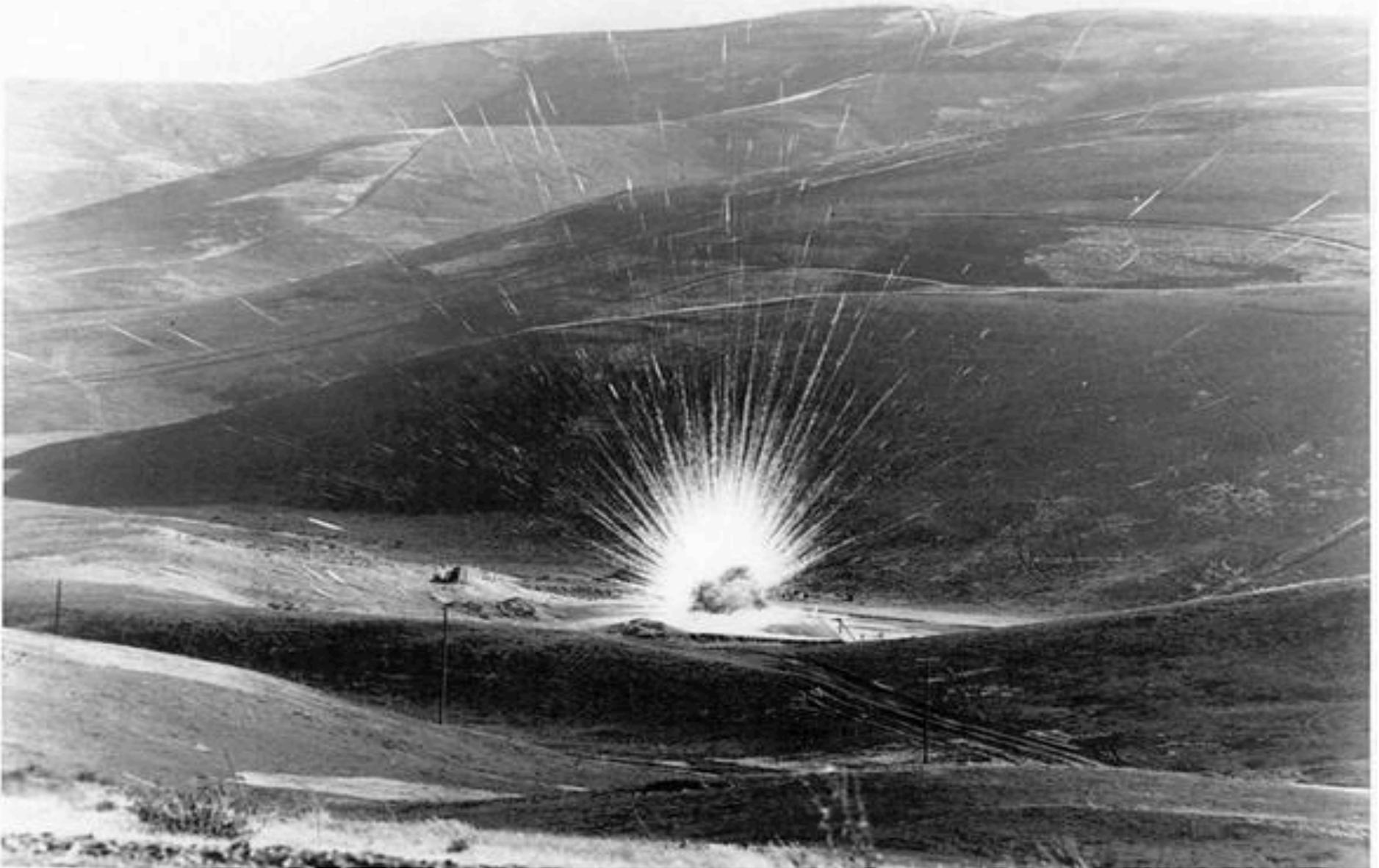
*En esta foto se ve una prueba hidrodinámica (núcleo de la bomba) en la consola de tiro. La luz explosiva es probablemente producto de pedazos de metal pirofórico lanzados en el aire (como uranio 238). El Uranio 238 es uno de los contaminantes de interés de la limpieza del sitio 300 Superfondo.*
